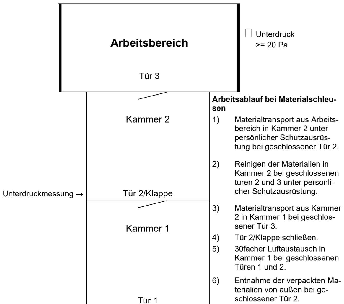
Abb. 2: Materialschleuse (Prinzipskizze)
